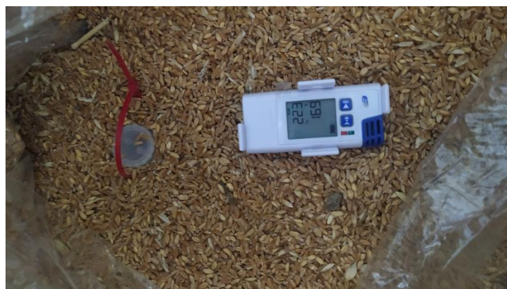
Εικόνα 20: Παγίδες probe σε διάφορα σημεία των σωρών και HOBO για την καταγραφή των συνθηκών και στα δυο χαρτοκιβώτια, καθ' όλη τη διάρκεια του πειράματος.
