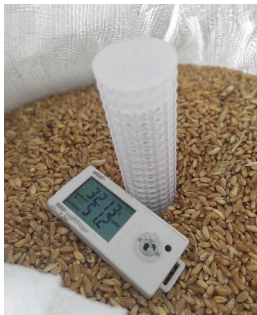
Εικόνα 8: Καταγραφή θερμοκρασίας και υγρασίας με χρήση HOBO, και δίπλα probe trap στο σωρό του δημητριακού.
