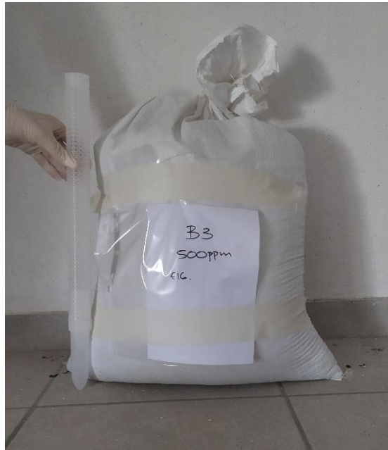
Εικόνα 7: Προσθήκη δειγματοληπτικής παγίδας probe στο σωρό του δημητριακού.
